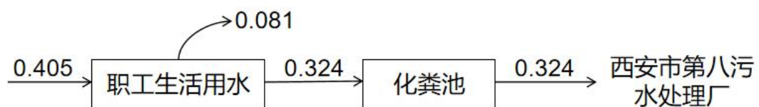
图 2-1 项目水平衡图 单位：m 3 /d
