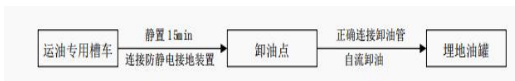
图5 柴油卸油工艺流程图
